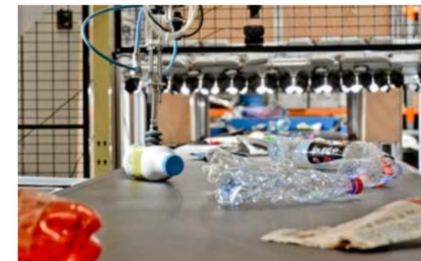
Max AI<sup>®</sup> est l'association d'un « œil », une simple caméra optique, et d'un « bras », robot articulé, pilotée par un « cerveau », réseau neuronal implanté dans un ordinateur. Afin qu'il puisse effectuer ses tâches correctement, il faut tout lui apprendre, autrement dit, enrichir suffisamment sa base de données (des centaines de milliers d'images en couleur y ont été versées). En bout de chaîne, un opérateur est présent pour compléter le robot et assurer le contrôle qualité.
